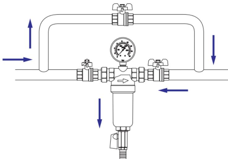
Если промывка не дает желаемого результата, необходимо почистить фильтрующий элемент, а при сильном загрязнении заменить его. Перед прочисткой или заменой фильтрующего элемента необходимо перекрыть входной запорный кран системы. Затем открыть промывной клапан и опорожнить участок трубопровода с фильтром. Для прочистки самого фильтрующего элемента следует открутить стакан, вынуть фильтрующий элемент, почистить или заменить его.
